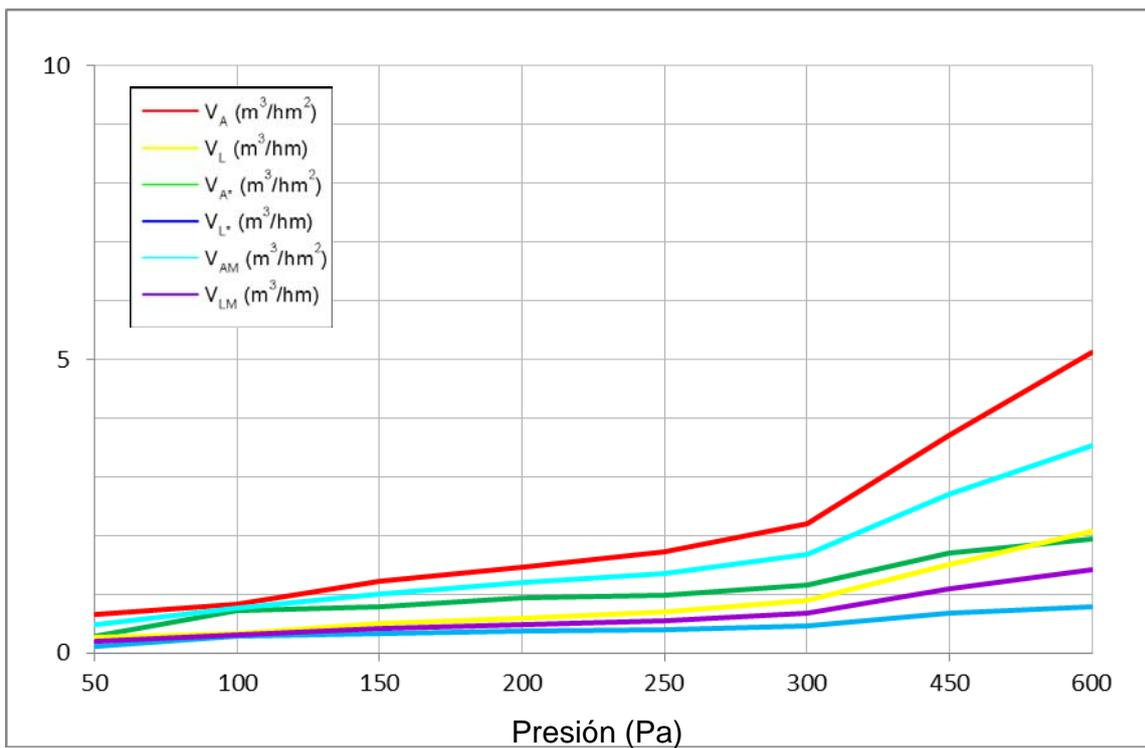
El gráfico siguiente representa el volumen de aire que pasa por la superficie total de la ventana (en  $m^3/hm^2$ ) y el volumen de aire que pasa por las juntas de apertura (en  $m^3/hm$ ) en función de la presión, según establece la norma UNE-EN 12207:2000 para obtener la clasificación de la ventana según su permeabilidad al aire.
