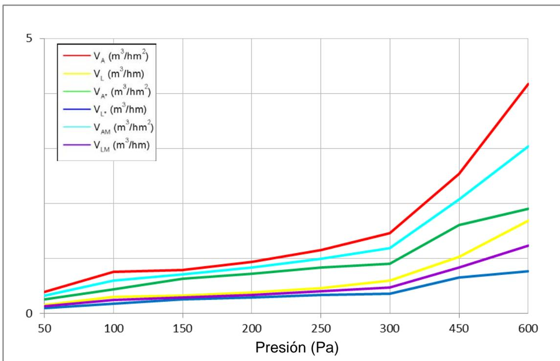
El gráfico siguiente representa el volumen de aire que pasa por la superficie total de la ventana (en  $\text{m}^3/\text{hm}^2$ ) y el volumen de aire que pasa por las juntas de apertura (en  $\text{m}^3/\text{hm}$ ) en función de la presión, según establece la norma UNE-EN 12207:2000 para obtener la clasificación de la ventana según su permeabilidad al aire.
