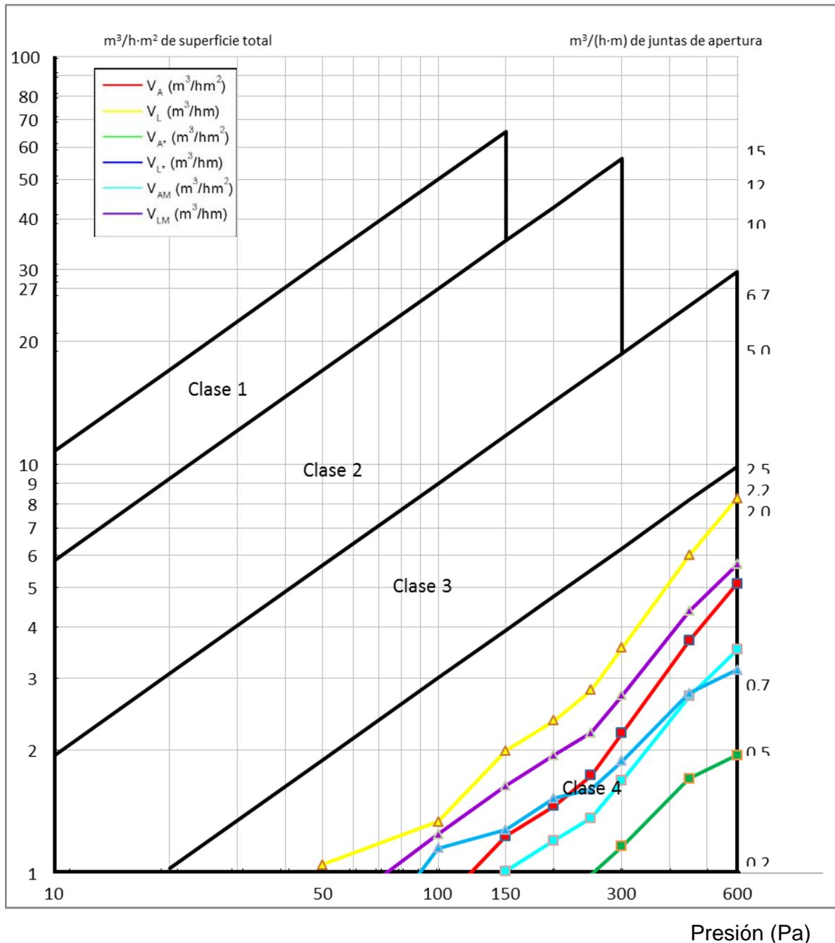
Clasificación según la junta de apertura (Presiones positivas): **Clase 4**
